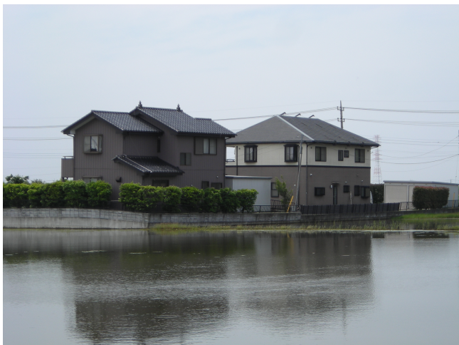
写真5 エリアAの住宅。東側から撮影。盛土が北東側に傾き、家屋も傾いている。
